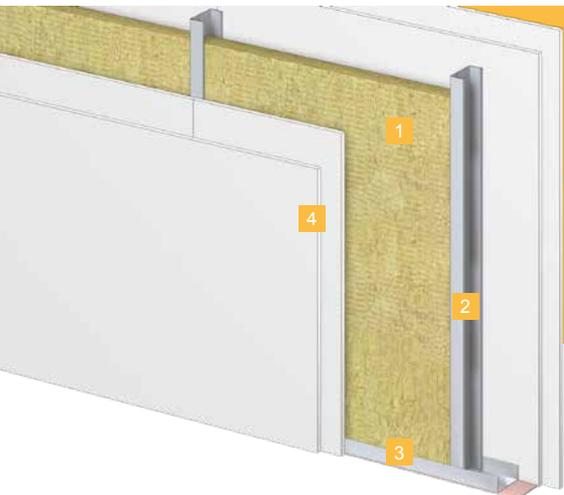
Die Grafik zeigt eine nichttragende Trennwand im Inneren von Gebäuden. Rahmen und Ständerwerk bestehen aus Metallprofilen und sind an beiden Seiten ein- oder zweilagig mit Gipskarton- oder Gipsfaserplatten beplankt. Als Füllung wird die ROCKWOOL Steinwolle-Trennwandplatte Sonorock für Schall- und Brandschutz genutzt.
