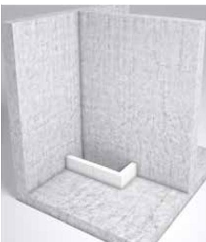
1. Ytong als Abmauerung für den Estrich setzen
