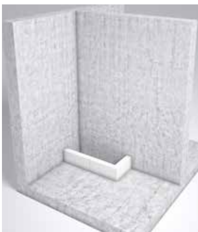
1. Ytong als Abmauerung für den Estrich setzen
